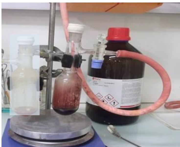
Figure 17: Synthèse sous atmosphère inerte du (R/S)-II ; techniques Schlenk.
