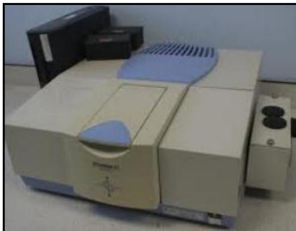
Figure 48 : Le spectromètre IR type FTIR -8201 PC Shimadzu
